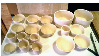
Abb. 21: Selbst im Schlickergussverfahren hergestellte Schmelzgefäße.
