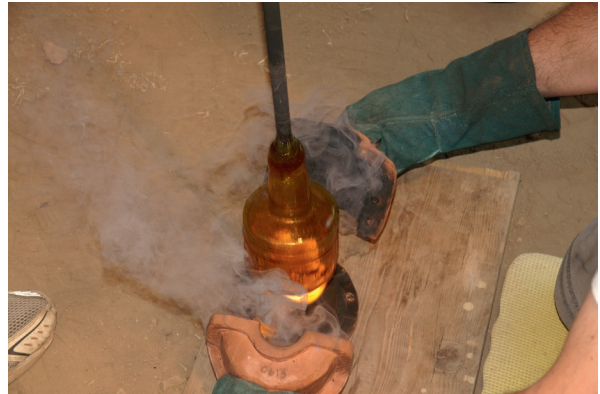
Abb. 14: Ennion-Schale (oben); Herstellen eines formgeblasenen Gefäßes.
