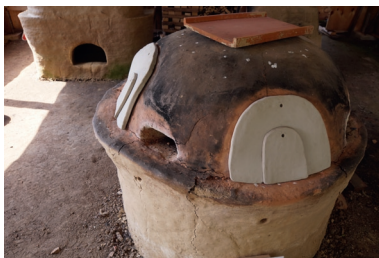
Abb. 20: Reduzierringe und Türen während der Trocknungsphase am Ofen.
