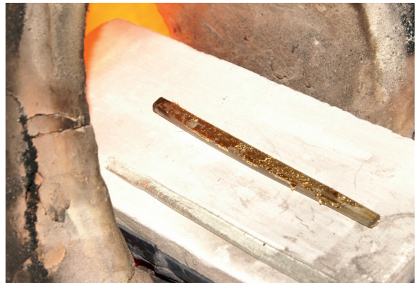
Abb. 33: Links: Aufbringen der Goldfolie; rechts: Einschließen der Goldfolien in die Glasbänder.
