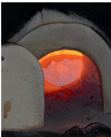
Abb. 22: Rohglasansatz im Schmelzofen.
