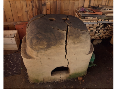
Abb. 19: Rissbildung während der Inbetriebnahme.
